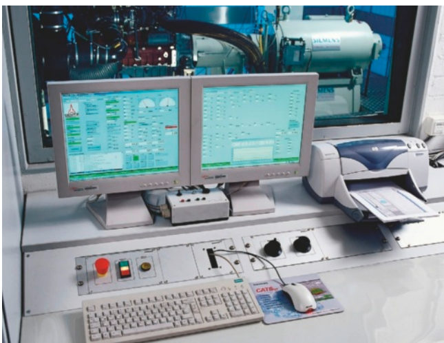
Bedienplatz mit dem Rechnersystem CATS NT Operator station with the CATS NT computer system
