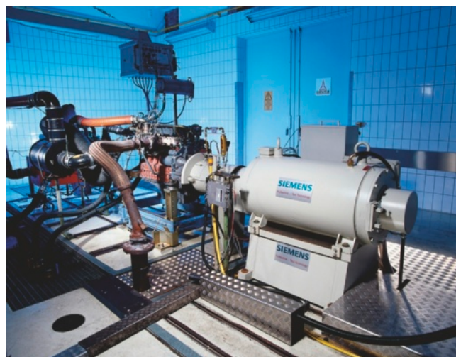
Motorprüfstand mit Drehstrom-Maschine 375 kW/ 1800 Nm Motor test stand with three-phase machine 375 kW/ 1800 Nm
